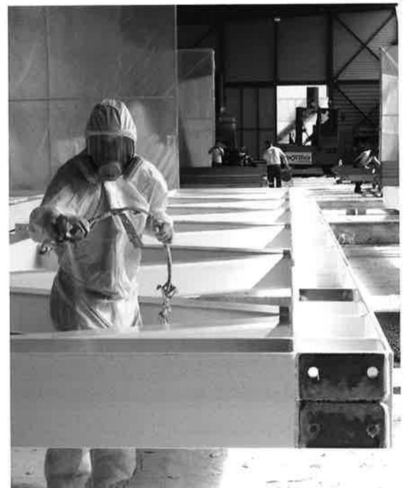
Fig. 51: Application du revêtement de protection incendie en usine
