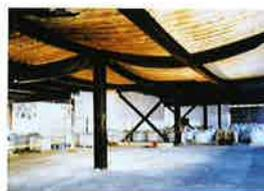
Fig. 33: Effet membrane des dalles mixtes et des poutres mixtes lors d'un des tests à Cardington
